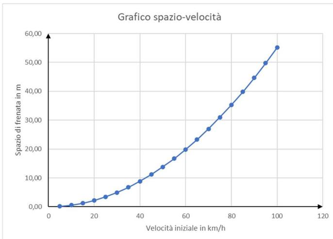
Il grafico spazio-velocità evidenzia la dipendenza dello spazio di frenata dalla velocità iniziale del veicolo ed è rappresentato da un ramo di parabola, perché lo spazio di frenata dipende dal quadrato della velocità, infatti, ponendo una velocità finale uguale a zero nella frenata, otteniamo:
