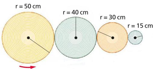
Se il primo disco ruota in senso antiorario, il secondo ruota in senso orario, il terzo in senso antiorario e il quarto, di conseguenza, **in senso orario**.
