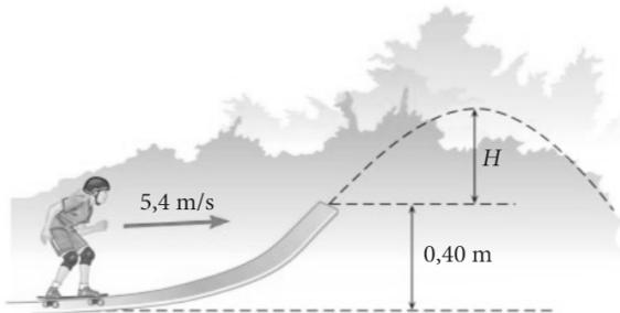
Considero tre punti principali, nel percorso della ragazza: il punto A, alla partenza (con altezza nulla e velocità data), il punto B, ovvero il punto di distacco dalla pista, e il punto C, quello ad altezza maggiore. Applico la legge di conservazione dell'energia meccanica:
