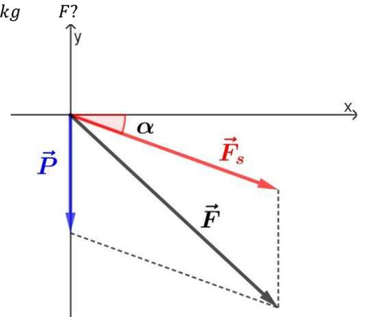
3. Un equilibrista di massa  $60,0 \text{ kg}$  cammina su una fune che è inizialmente orizzontale. Quando si trova a metà del percorso, il suo peso incurva simmetricamente la fune, che forma un angolo di  $4,8^\circ$  con l'orizzontale. Qual è la tensione della fune?
