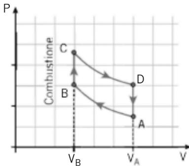
Posso determinare le relazioni tra le temperature dei vari stati, usando le relazioni tra le grandezze di una trasformazione adiabatica, in particolare quella tra temperatura e volume, considerando le trasformazioni AB e CD:
