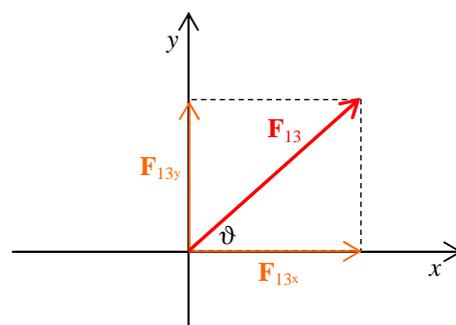
Da quest'ultima, con la formula inversa, possiamo determinare l'angolo formato da  $F_{13}$  con l'asse x, ovvero la direzione della forza stessa:  $\vartheta = \text{arctg} \frac{F_{13y}}{F_{13x}}$  (sulla calcolatrice scientifica dovremo digitare:  $\vartheta = \text{tg}^{-1} \frac{F_{13y}}{F_{13x}}$ ).
